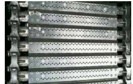
Ausstattung von Raupenband-Maschinen mit neuen Verschleißteilen.
