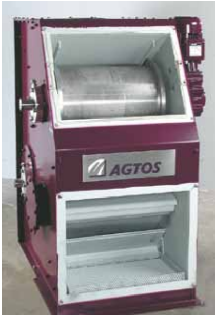
Nachrüstung von Strahlanlagen mit Magnetwindsichtern zur Trennung von Strahlmittel und Sand.
