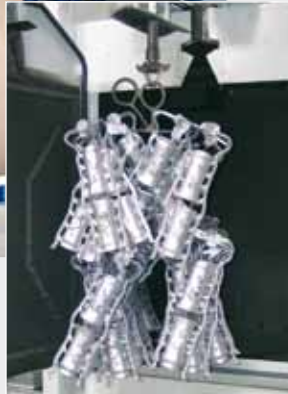
Hängetransport-Strahlanlagen werden als Insellösung oder für den Durchlaufbetrieb konstruiert.
