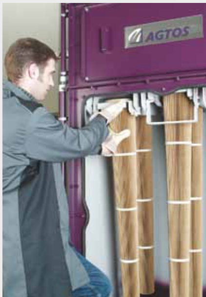
Der Tausch der Filterpatronen erfolgt jetzt sauber, einfach und schnell.
