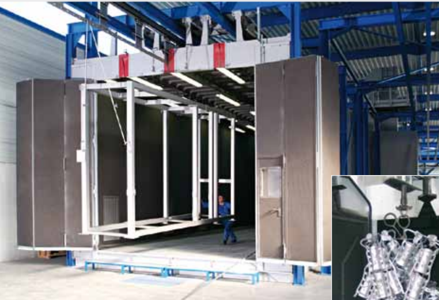
Hängetransport-Strahlanlagen werden als Insellösung oder für den Durchlaufbetrieb konstruiert.
