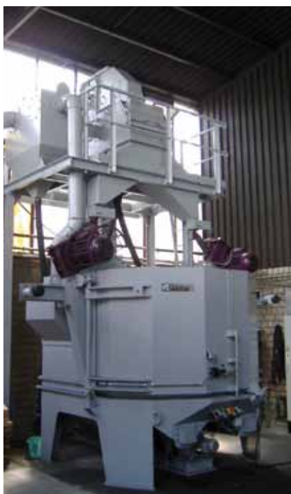
Oczyszczarka strumieniowo-ścierna z stołem obrotowym.
