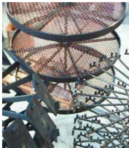
Zawieszki dla elementów czyszczonych w oczyszczarkach strumieniowo-ściernych z podwieszonym wysięgnikiem.
