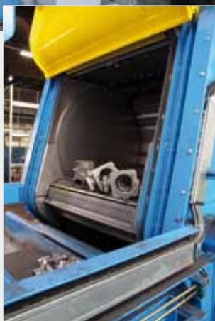
Oczyszczarka strumieniowa z taśmą nieckową z elementami kuźniczymi.
