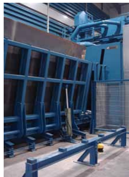
Oczyszczarka strumieniowa rolkowa do transportu w pozycji pionowej.
