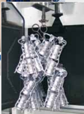
Oczyszczarki strumieniowo-ścierne z podwieszonym wysięgnikiem konstruowane są jako urządzenia do zbiorowego śrutowania detali lub też jako przeznaczone do pracy przelotowej.
