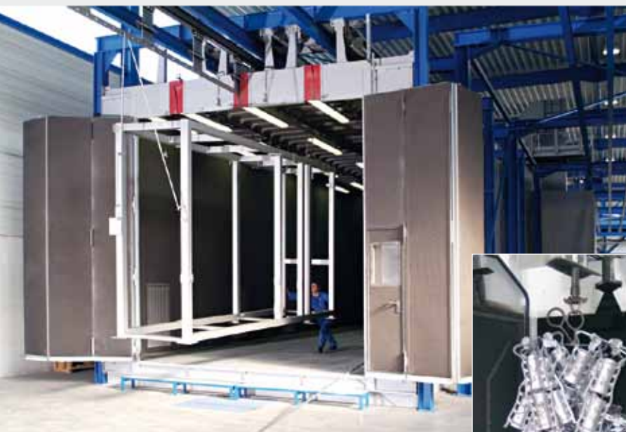
Oczyszczarki strumieniowo-ścierne z podwieszonym wysięgnikiem konstruowane są jako urządzenia do zbiorowego śrutowania detali lub też jako przeznaczone do pracy przelotowej.
