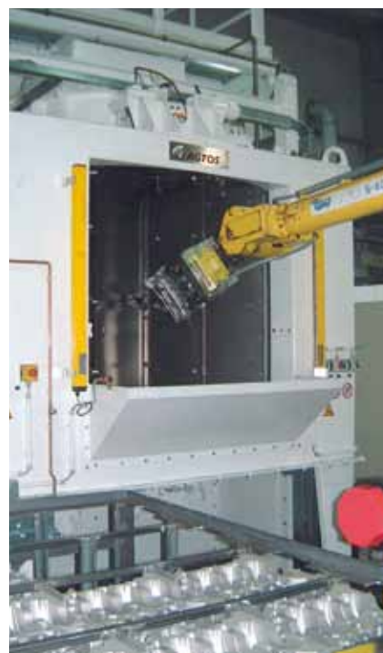
Zautomatyzowana oczyszczarka strumieniowo-ścierna z satelitarnym taktowym stołem obrotowym dla odlewów.
