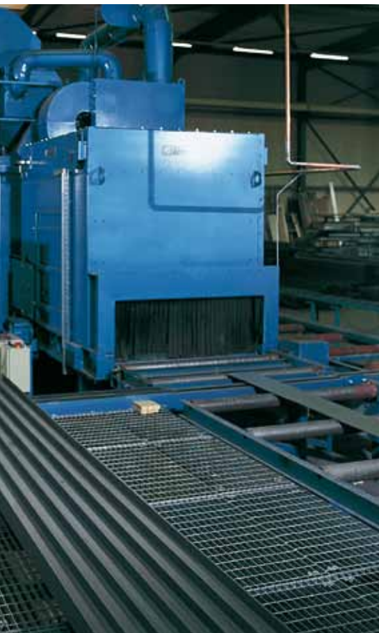
Oczyszczarka strumieniowo-ścierna z przenośnikiem rolkowym z powiększonym przelotem, przeznaczona do śrutowania konstrukcji.
