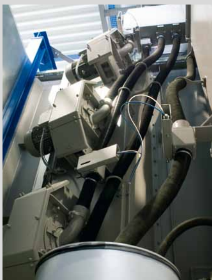
Wysokowydajna turbina AGTOS w przelotowej oczyszczarce zawieszkowej.
