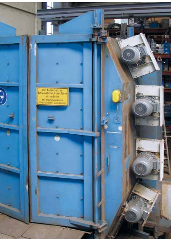
Wysokowydajne turbiny AGTOS są często stosowane w celu zwiększenia wydajności starszych oczyszczarek strumieniowych, tutaj np. w maszynie zawieszkowej.
