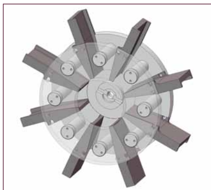
Wirnik dwutarczowy z 8 łopatkami turbinowymi i bolcami dystansowymi.
