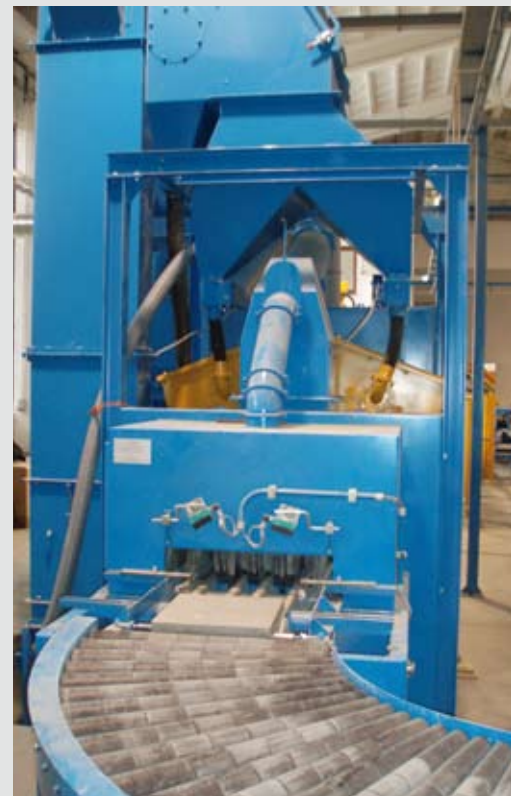
Betonplatte beim Verlassen der Strahlanlage
