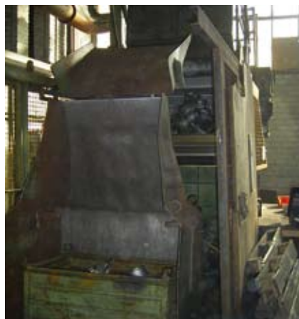
Raupenband-Strahlanlage R3 vorher...
