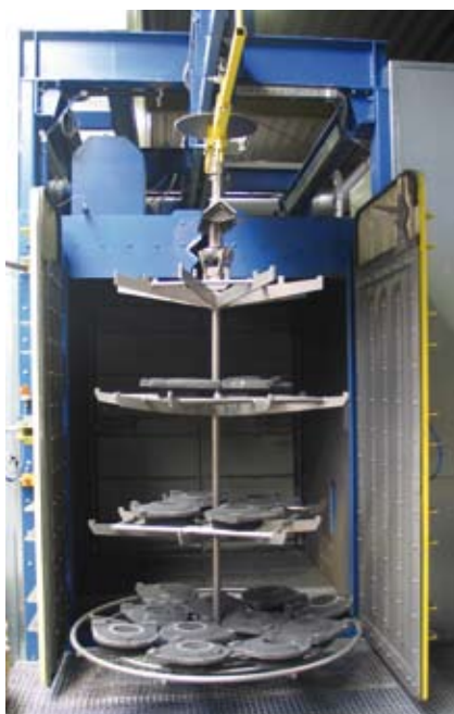
Werkstücke vor der AGTOS-Durchlaufhängebahn- Strahlanlage
