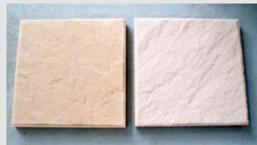
Betonplatten vor und nach dem Strahlprozess
