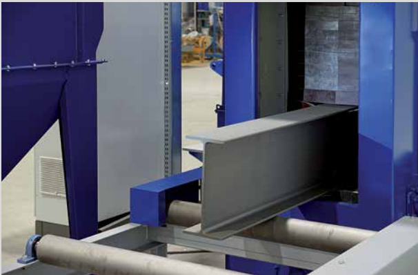
Ein Stahlträger nach dem Strahlvorgang
