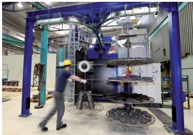
Manuelle Be- und Entladung der Durchlaufhängebahn-Strahlanlage
