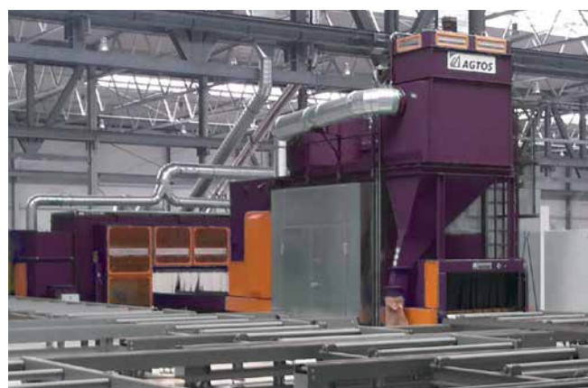
Eine AGTOS Rollbahn-Strahlanlage mit nachgeschalteter Lackieranlage und Trockner
