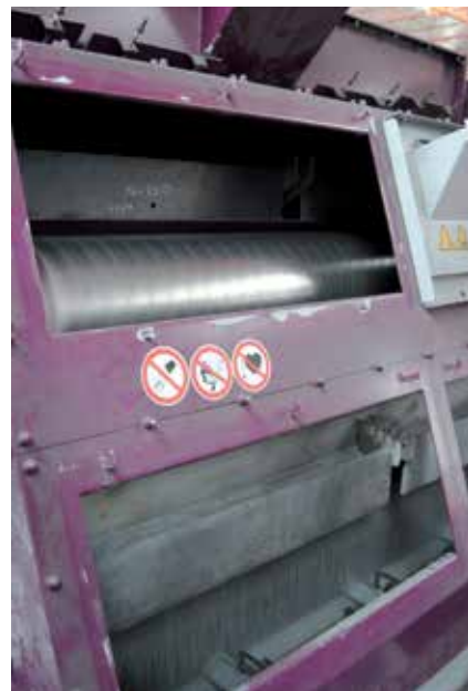
Magnet-/ Windsichtung mit Magnetwalze und Strahlmittelschleier
