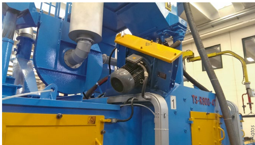
Durch die Montage von Hochleistungsturbinen in dieser Drahtgurt-Strahlanlage konnte in einer Härterei die Bandgeschwindigkeit signifikant erhöht werden. Auch die Standzeiten der Verschleißteile verlängerten sich deutlich.
