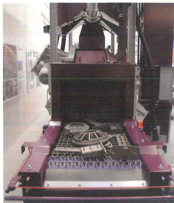
Gussteile vor einer AGTOS-Drahtgurtstrahlanlage. | Foto: AGTOS
