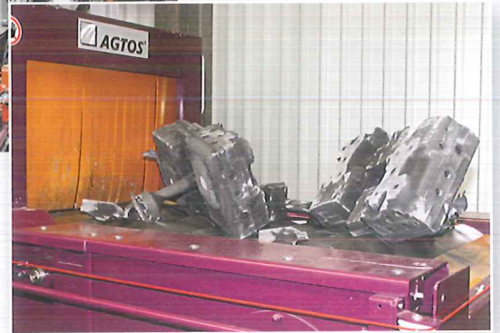
Die Gusssteile vor (unten)... ... und nach (links) der Bearbeitung in der neuen Ricochetanlage.
