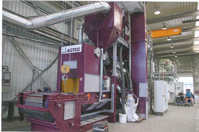
Die Unterschiede zwischen dieser Ricochet- und einer herkömmlichen Strahlanlage sind nur schwer erkennbar: Auf der Unterseite fehlen die Turbinen und das Förderband ist mit Platten belegt.
