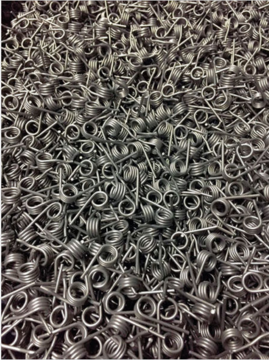
Diese Schenkelfedern sind ein Beispiel für ein Produkt, das mit Edelstahl gestrahlt wird. (Kugel-Strahltechnik)
