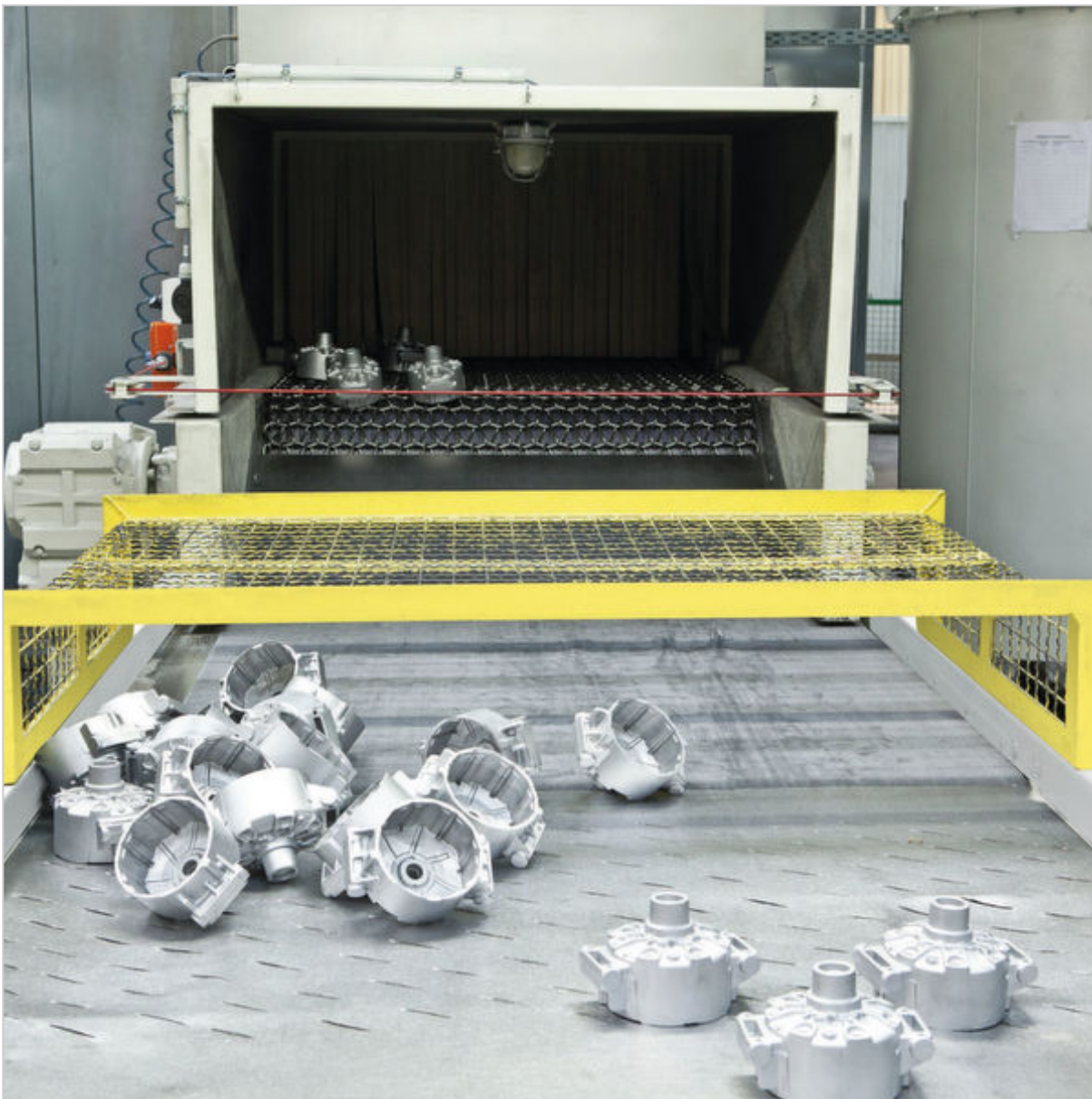
Aluminiumdruckgussteile am Auslauf einer Drahtgurt-Strahlanlage. Mit diesem Anlagentyp lassen sich Massenteile kontinuierlich mit Aluminium strahlen. (Agtos)
