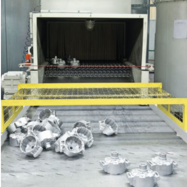
Aluminiumdruckgussteile am Auslauf einer Drahtgurt-Strahlanlage. Mit diesem Anlagentyp lassen sich Massenteile kontinuierlich mit Aluminium strahlen. (Bild: Agtos)
