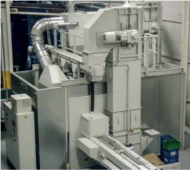
Walzentransport-Strahlanlage für die Verfestigung von langen, instabilen Spiralfedern
