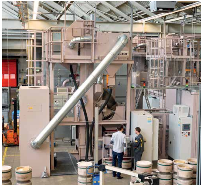
AGTOS Trommel-Strahlanlage im Betrieb
