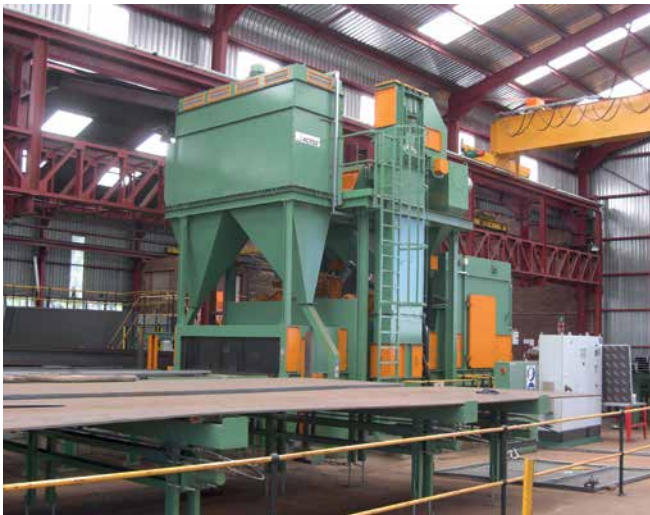
AGTOS Rollbahn-Strahlanlage RT 26 zum Reinigen und Entzundern von Blechen und Profilen.
