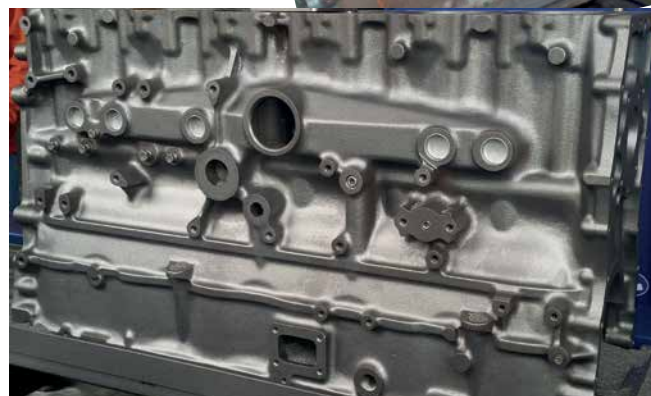
Motorblock vor und nach dem Strahlprozess mit dem AGTOS OCEAN BLASTER
