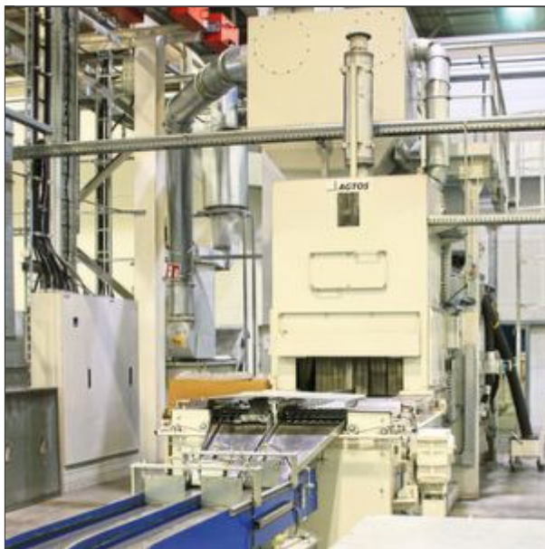
Auslaufseite einer der Agtos-Strahlanlagen bei AE in Gerstungen – sie sind speziell auf das Strahlen von Aluminium ausgelegt. (Bild: Vollrath)
