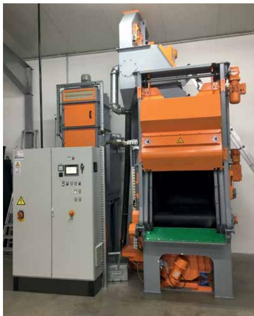
*Stand-Alone-Lösung mit Filter und Schaltschrank*
