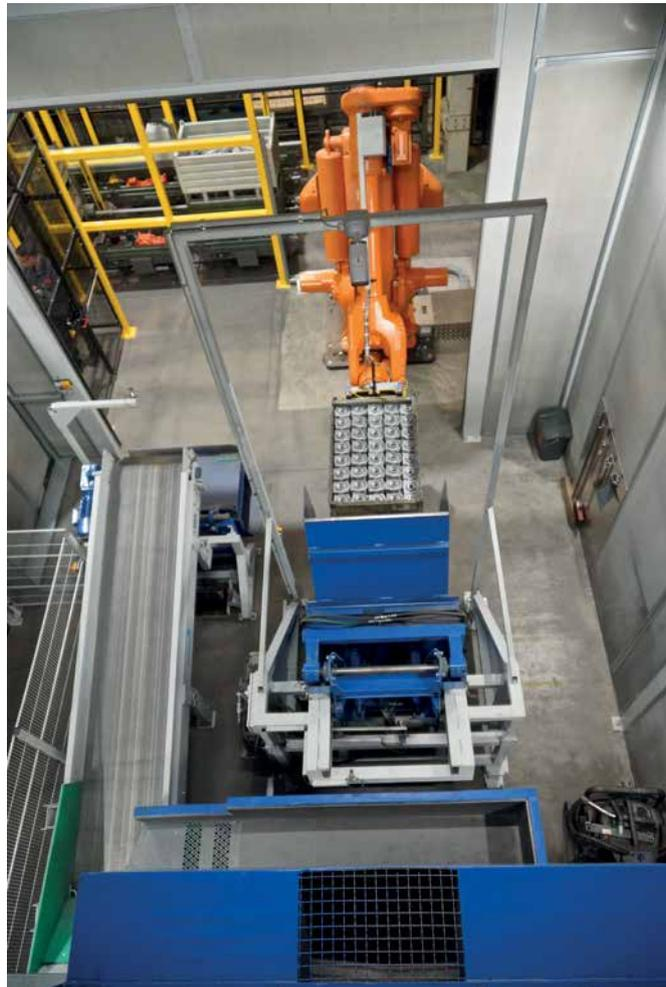
*Beladung des Beschickers der **AGTOS** Muldenband-Strahlanlage mittels Roboter*
