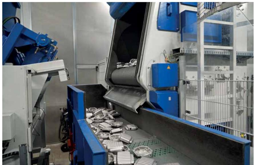
*Entladung der Strahlmaschine und Rückführung der Werkstücke in die bereitgestellte Kiste*
