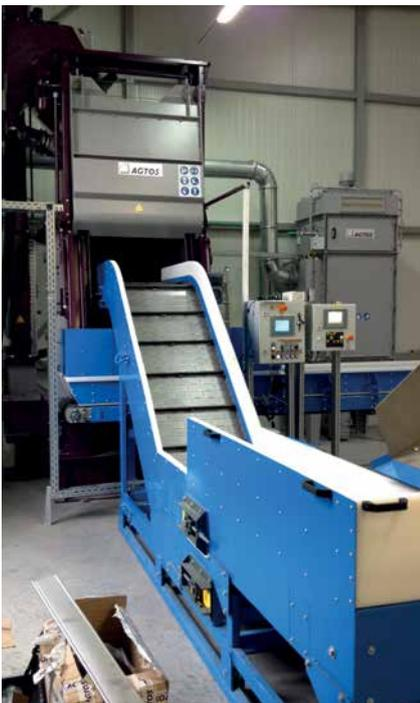
*Muldenband-Strahlanlage mit Spezial-Beschickungs-Einrichtung*
