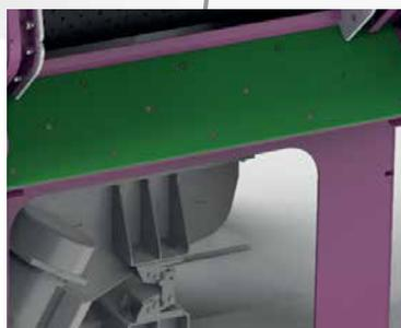
Schonender Austrag der Werkstücke durch Ausfallklappe mit Gummiauflage
