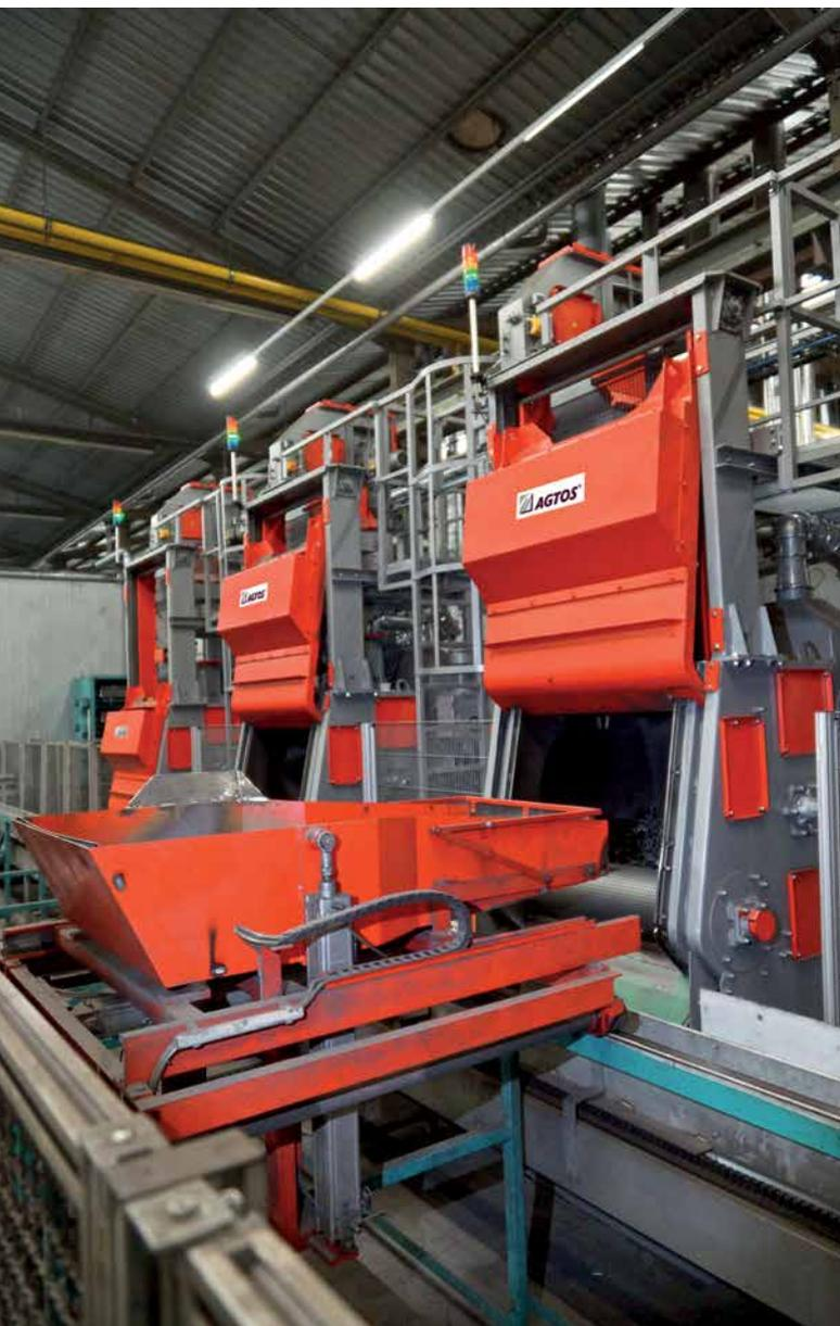
*Schonende Beladung der Strahlmaschinen mittels Beschickungseinrichtung*
