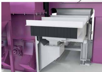
Strahlmittelreinigung durch eine Vibririnne zum sofortigen Austrag von Graten und Abfallteilen
