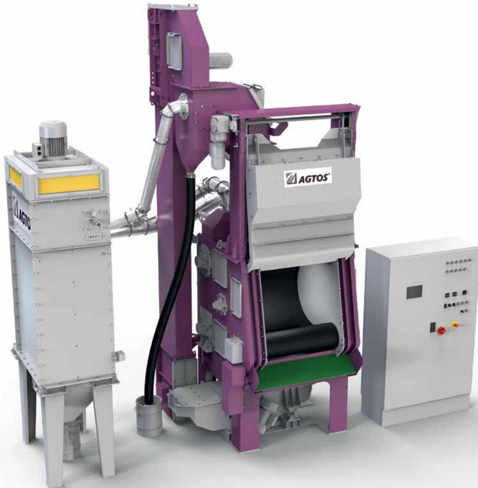
Das Muldenbandprinzip hat sich als eines der effektivsten Strahlverfahren zum Entzndern, Entrosten und Entgraten von Massenteilen durchgesetzt. Die zu strahlenden Werkstücke werden durch das laufende Endlos-Gummimuldenband schonend umgewälzt und während der gesamten Strahlzeit gleichmäßig dem Schleuderstrahl ausgesetzt. Überzeugen Sie sich von den Vorteilen der **AGTOS**-Strahltechnik.
