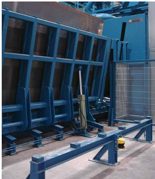
Oczyszczarka strumieniowa z pionowym przenośnikiem rolkowym
