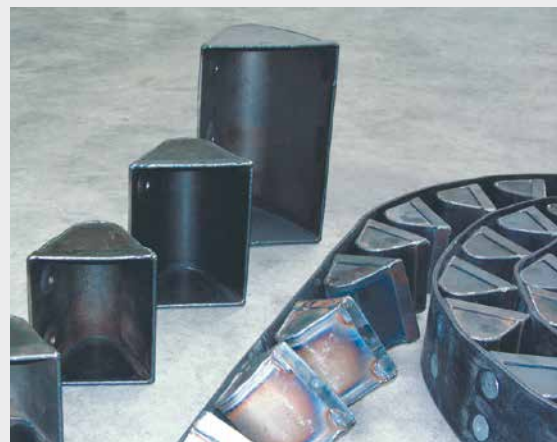
Pasy przenośnika kubłkowego, kubelki i śruby dla wszystkich rodzajów oczyszczarek strumieniowo-ściernych.
