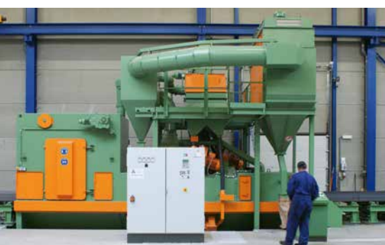
Oczyszczarka AGTOS z wyraźnie widocznymi drzwiami inspekcyjnymi
