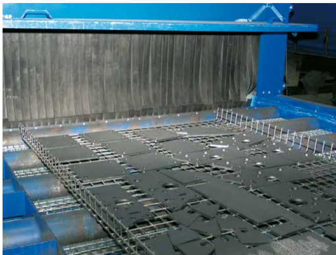
Obróbka strumieniowa drobnych elementów wypalanych w koszu
