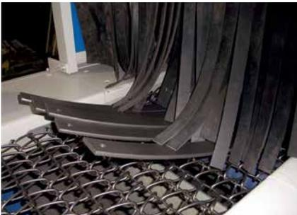
*Auslauf einer Drahtgurt-Strahlanlage zum Verfestigen von Blattfedern*
