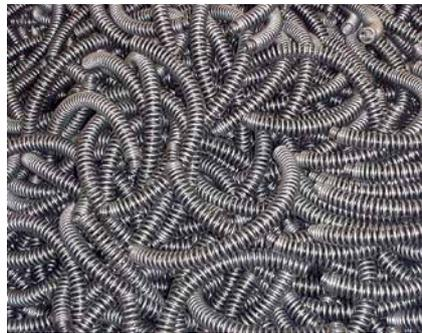
Bogenfedern nach dem Strahlen in einer Muldenband-Strahlanlage
