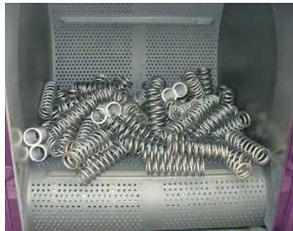
Muldenband-Strahlanlage zum Verfestigen von Schraubenfedern
