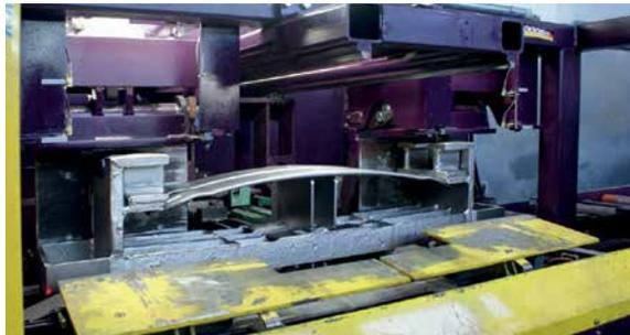
*Vorspanneinrichtung für Blattfedern vor der Bearbeitung in einer Rollbahn-Strahlanlage*
