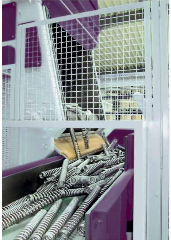
*Raupenband-Strahlanlage zum Verfestigen von Schraubenfedern*
