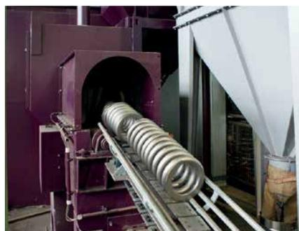
*Ein- und Auslauf einer Walzentransport-Strahlanlage für das Reinigen von Schraubenfedern*
