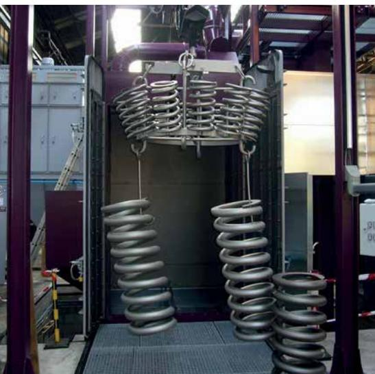
Hängbahn-Strahlanlage zum Bearbeiten von Schraubenfedern. Der Strahlraum misst 1.700 x 1.700 mm.
