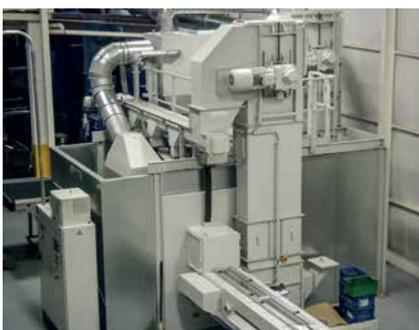
*Walzentransport-Strahlanlage für die Verfestigung von langen Spiralfedern*
