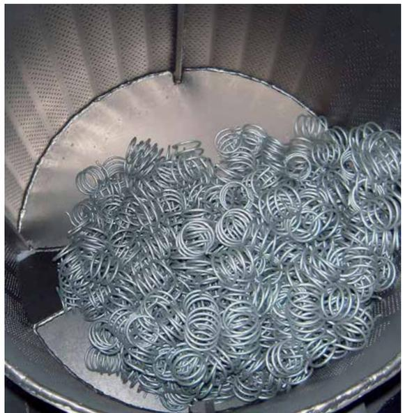
*Trommel-Strahlanlage zum Verfestigen von Schraubenfedern*
