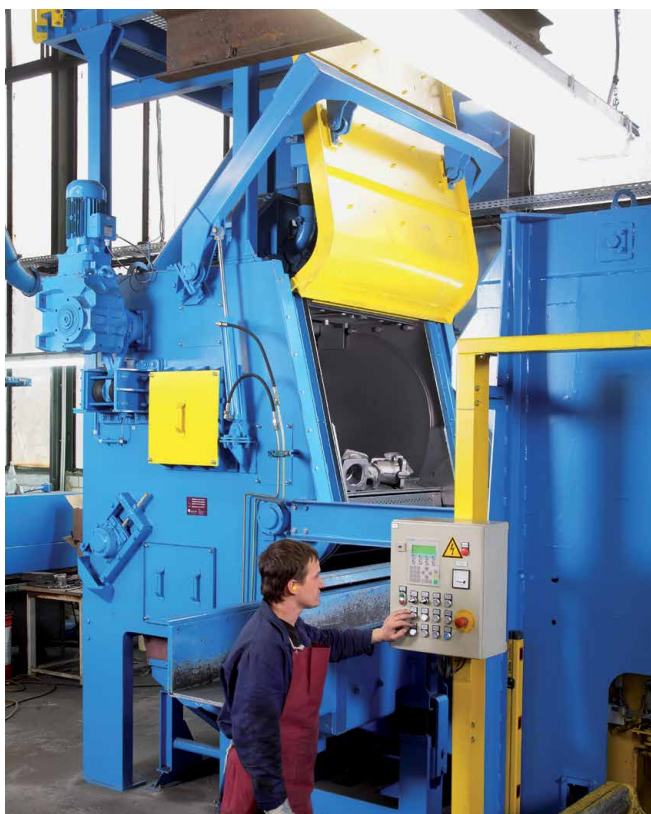
Oczyszczarka strumieniowa z taśmą gąsienicową MR 550 jako urządzenie samodzielne w zakładzie kuźniczym.
