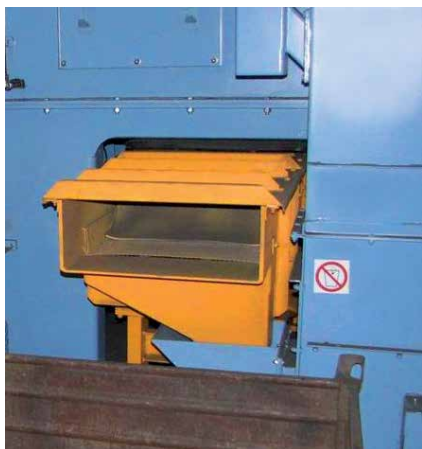
Ilustr. 1: Rynna wibracyjna do usuwania części zgrubnych ze ścierniwa
