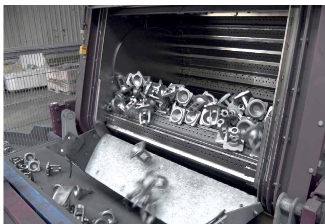
Oczyszczarka strumieniowa z taśmą gąsienicową Typ MR 0270 dla odlewów
