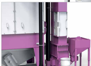
Przeñośnik kubekowy z odpowiednio zwymiarowanymi otworami rewizyjnymi
