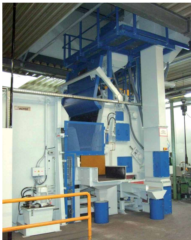
Oczyszczarka strumieniowa z taśmą gąsienicową MR 750 służąca do utwardzania sprężyn.
