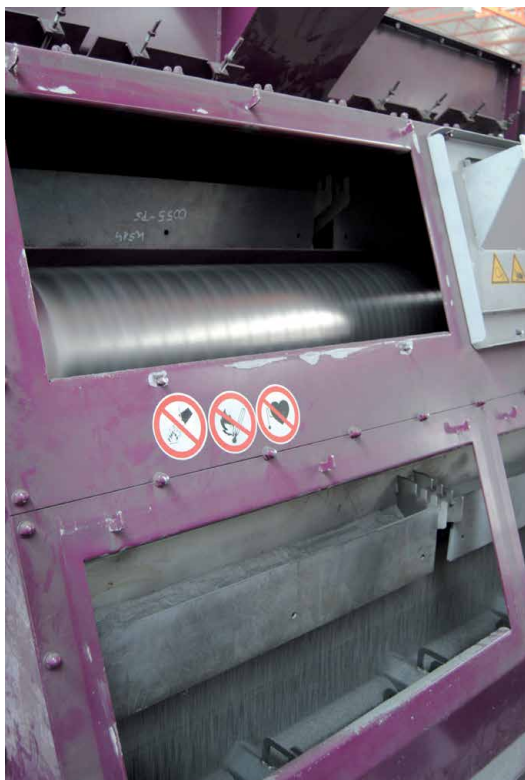
Ilustr. 4: Separacja magnetyczna/powietrzna z wałkiem magnetycznym i strumieniem ścierniwa
