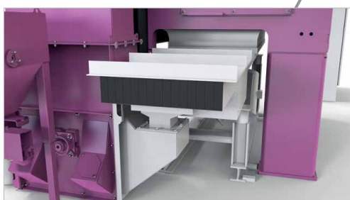
Oczyszczanie ścierniwa przy pomocy rynnny wibracyjnej w celu natych- miastowego usunięcia zadziórów i elementów odpadowych
