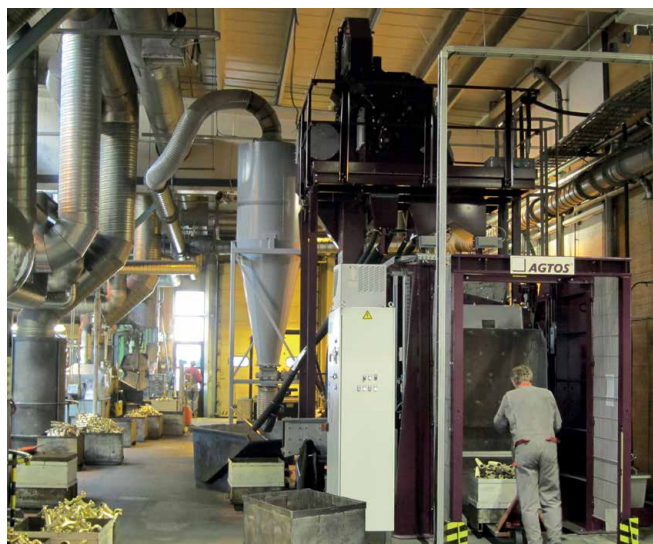
Oczyszczarka strumieniowa z taśmą gąsienicową MR 270 do obróbki strumieniowej elementów armatur.
