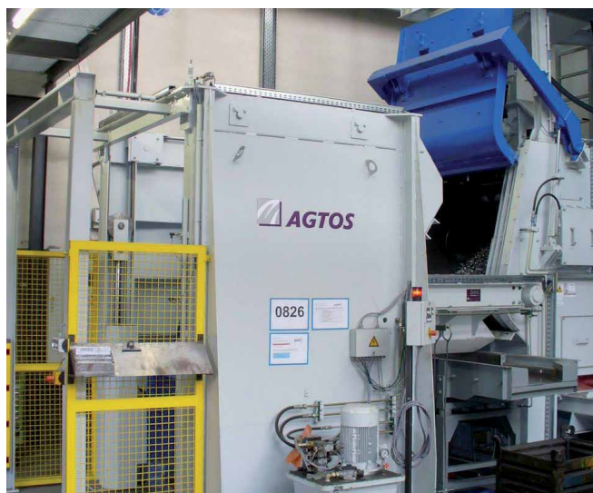
Oczyszczarka strumieniowa z taśmą gąsienicową MR 550 z urządzeniem załadowniczym i rynną wibracyjną do obróbki komponentów silnikowych.
