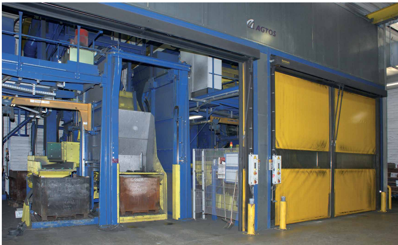
Oczyszczarki strumieniowe z taśmą gąsienicową MR 850 pracujące równoległe w odlewni. Bramy szybkie zapewniają bezpieczeństwo pracy i ochronę przed hałasem.
