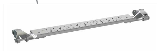
Łączniki taśmy gąsienicowej z powłoką manganową umożliwiające dłuższe okresy przestoju
