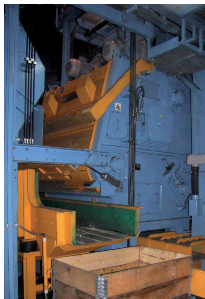
Oczyszczarka strumieniowa z taśmą gąsienicową MR 850 z urządzeniem załadowniczym i rynną wibracyjną do obróbki odlewów.
