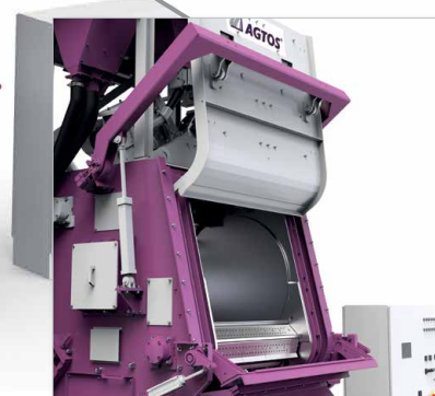
Drzwiczki podnoszone z dwoma siłownikami zapewniającymi równo- mierne i obustronne uszczelnienie
