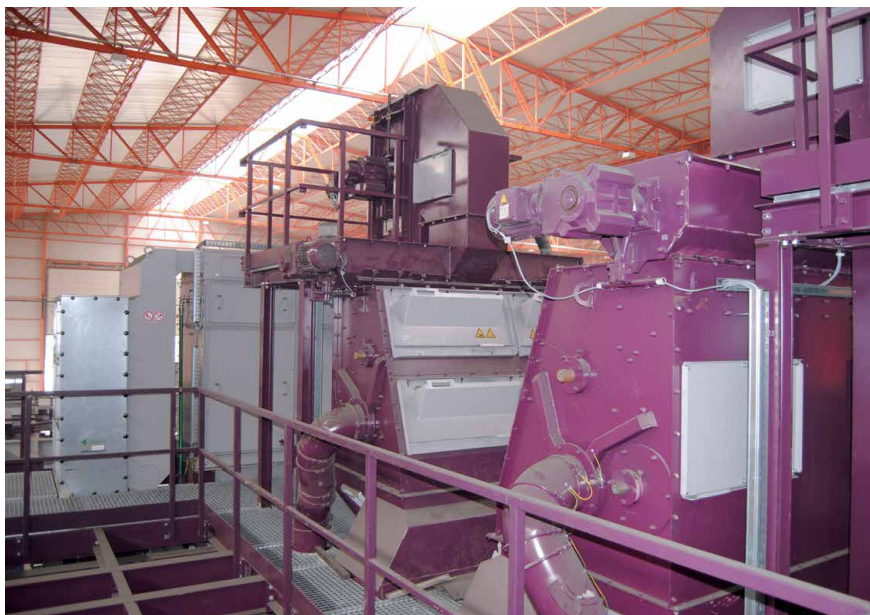
Ilustr. 2: Separacja magnetyczna/powietrzna w dużej instalacji odlewniczej
