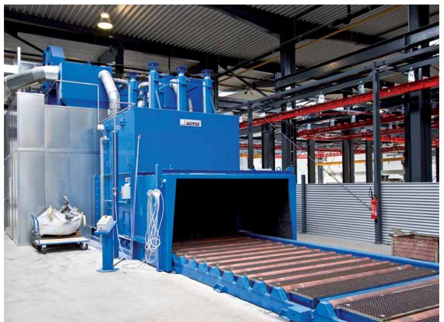
*Rollbahn-Strahlanlage zum Reinigen von Schweißkonstruktionen*
