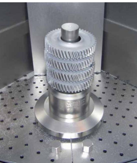
*Satelliten-Taktdrehtisch-Strahlanlage zum Verfestigen von Getriebeteilen*
