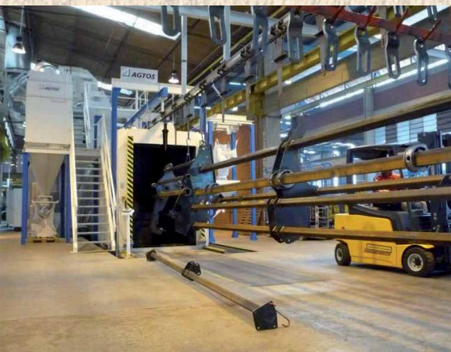
Durchlaufhängebahn-Strahlanlage zum Reinigen von Schweißkonstruktionen
