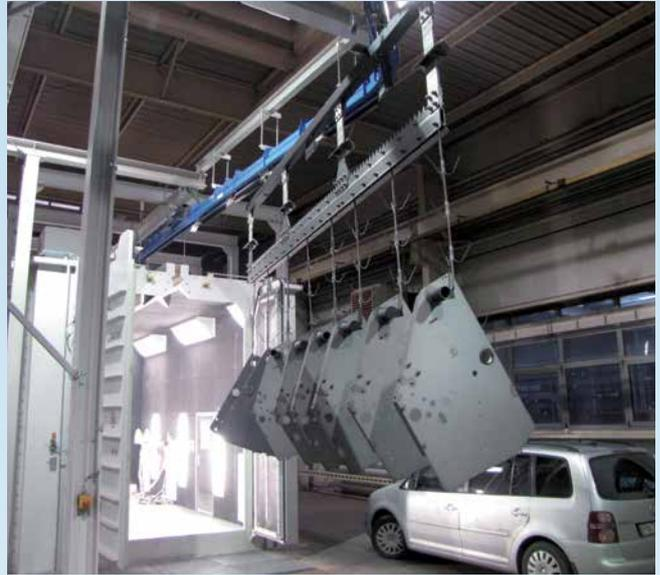
Durchlaufhängebahn-Strahlanlage zum Reinigen von Konstruktionsteilen
