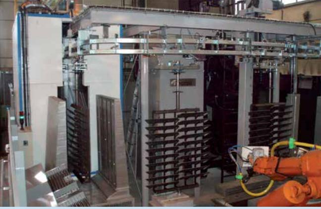
Durchlaufhängebahn-Strahlanlage zum Reinigen von Zuschnitten
