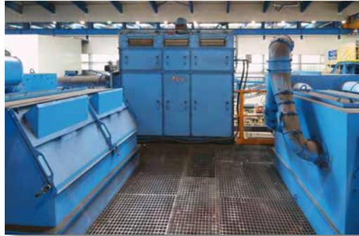
Système de filtration à cartouches et séparateur d'air pour nettoyer l'abrasif de la poussière et des fines
