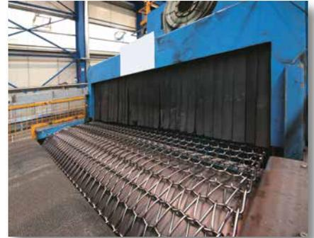
Côté de sortie des pièces avec ventilateur de soufflage
