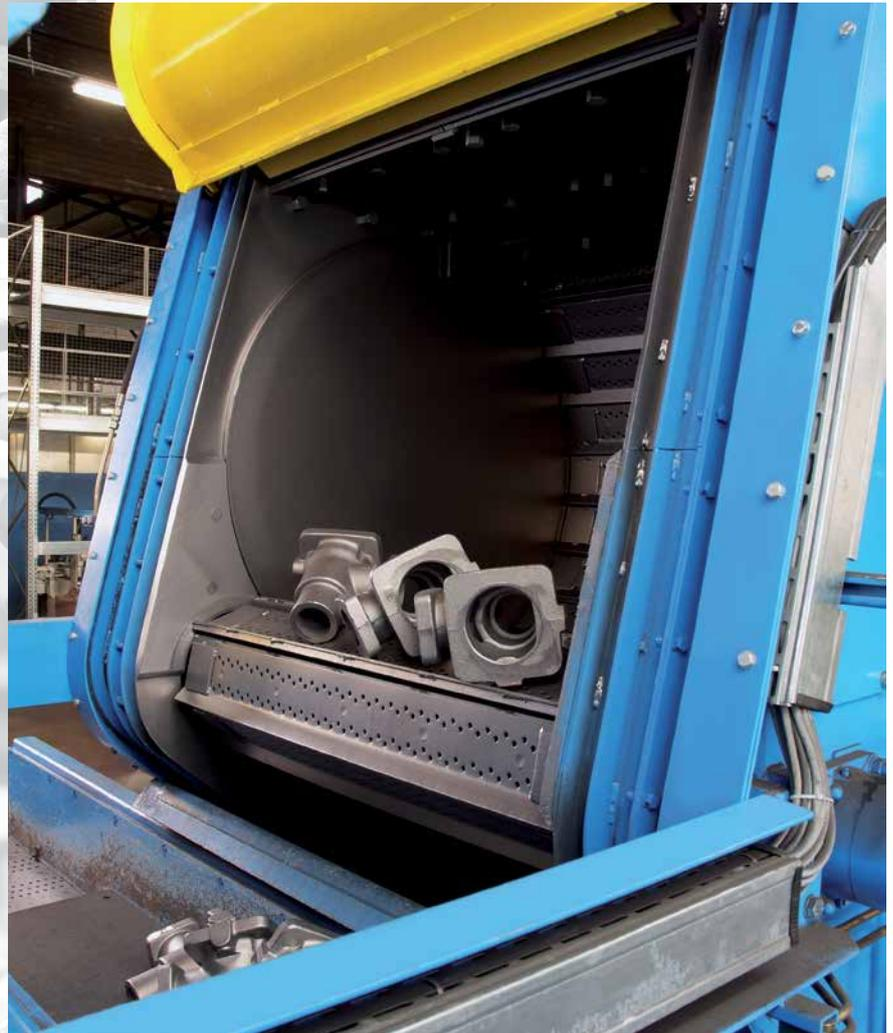
Les grenailleuses à tablier retourneur métallique sont utilisées pour ébavurer, décalaminer, dessabler et décaper. Elles sont exploitées aussi bien comme solution autonome qu'attachées en ligne avec une chaîne. **AGTOS** livre ces machines dans de nombreux modèles et de nombreuses tailles, en plus du programme standard. Les machines sont équipées de turbines à haute performance **AGTOS** et de filtres de dépoussiérage à cartouches de maintenance simple.
