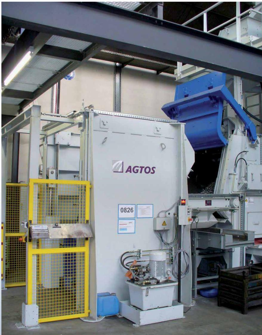
*Grenailleuse à tablier retourneur métallique MR 550 avec chargeur et couloir vibrant pour le traitement de composants de moteur.*
