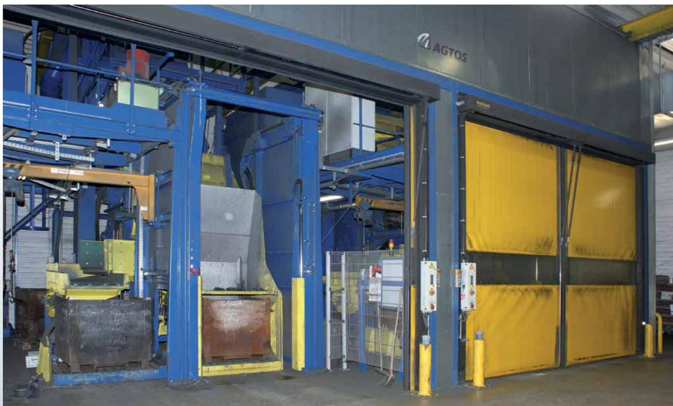
Grenailleuses à tablier retourneur métallique MR 850 en mode jumelé dans une fonderie. Les portes à ouverture rapide servent à la sécurité du travail et à l'insonorisation.
