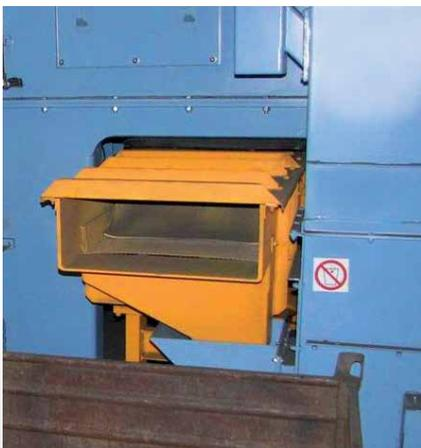
Fig. 1 : Couloir vibrant pour le déversement de grosses pièces de l'abrasif
