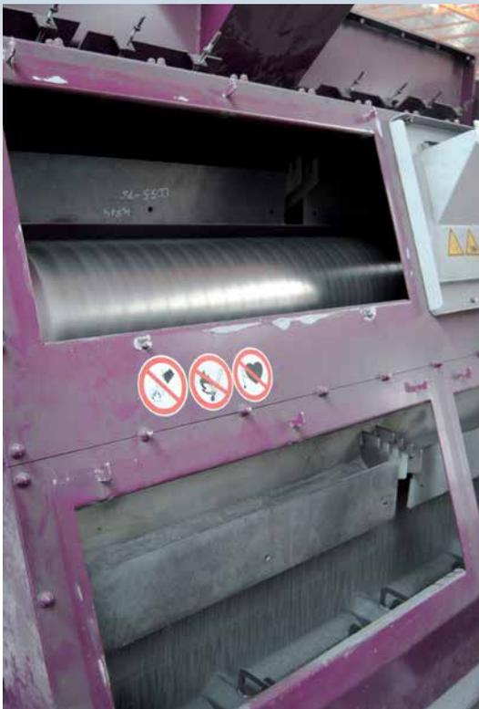
Fig. 4 : Séparation d'air/séparation magnétique avec cylindre magnétique et pellicule abrasive
