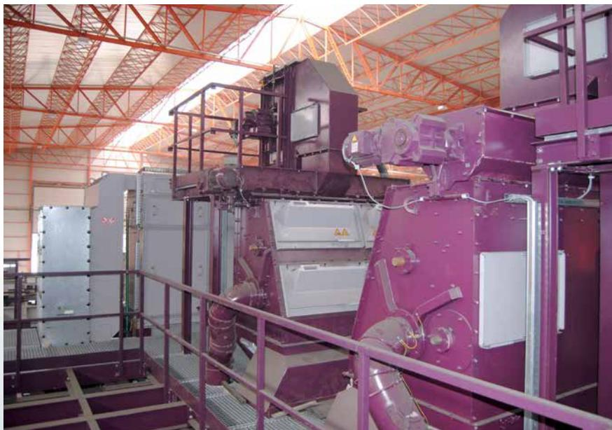
Fig. 2 : Séparation d'air et séparation magnétique dans une grande installation de fonderie
