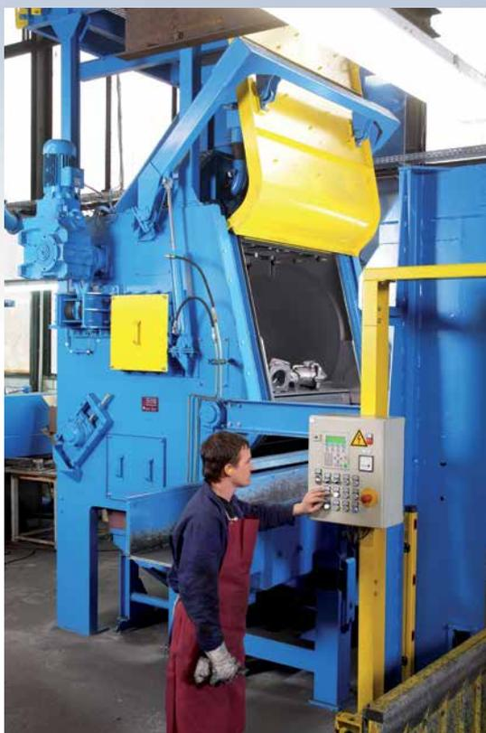
La grenailleuse à tablier retourneur métallique MR 550 comme solution autonome dans une forge.
