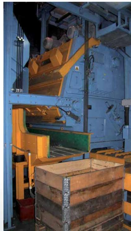
*Grenailleuse à tablier retourneur métallique MR 850 avec chargeur et couloir vibrant pour le traitement de pièces coulées.*
