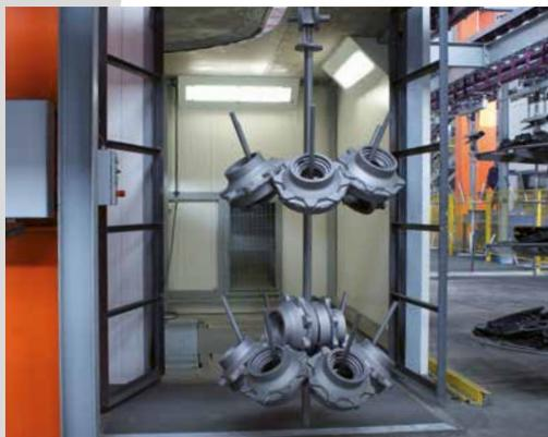
*Pièces forgées sortant de la chambre de dépeussierage manuel d'une grenailluse à charge suspendue à chambre double.*
