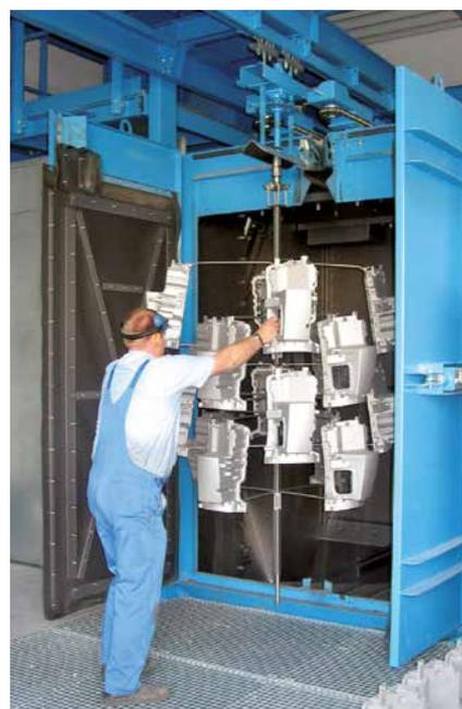
*Grenailleuse à charge suspendue dans la fonderie avec séparateur magnétique et récupération des abrasifs devant la machine*
