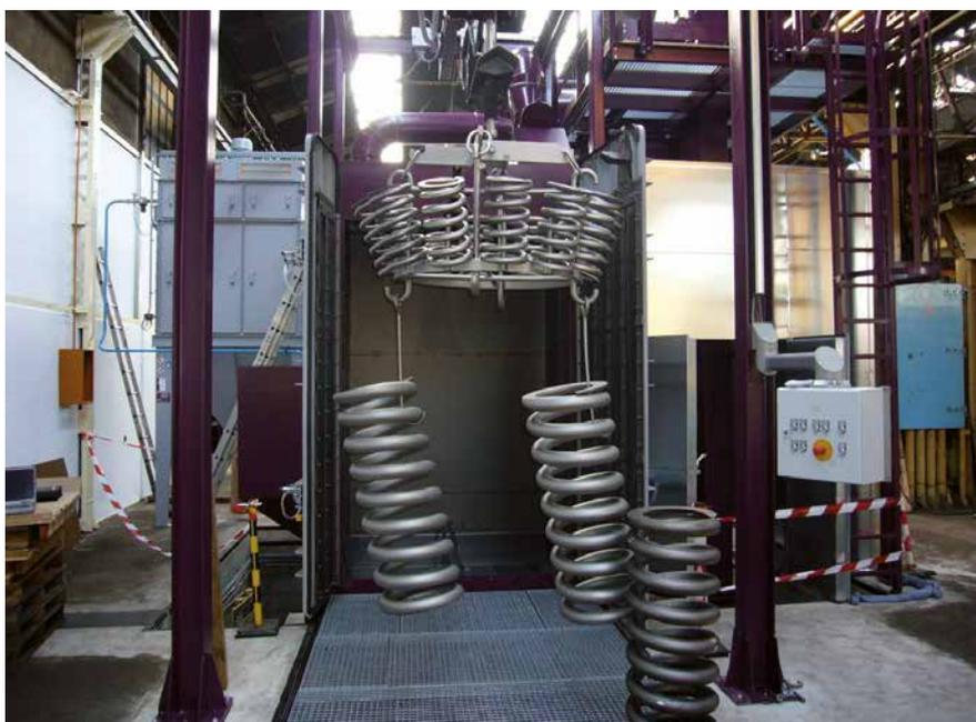
*Grenailleuse à charge suspendue avec base et récupération des abrasifs pour le traitement de ressorts*
