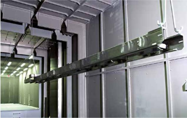
*Grenailleuse continue à charge suspendue pour constructions soudées avec espace de post-grenailage et dépolissage manuel*
