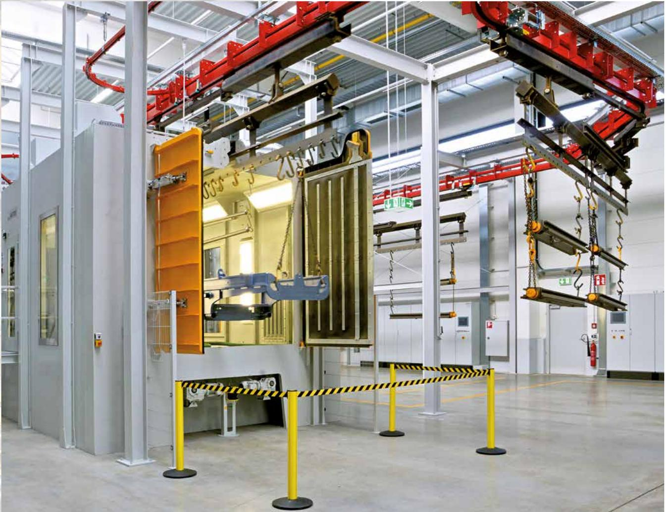
Les grenailleuses à charge suspendue se déclinent en de nombreuses variantes, modèles et tailles. Elles nécessitent une surface d'appui relativement petite. Susceptibles d'être facilement intégrées dans la logistique interne, elles sont très répandues.
