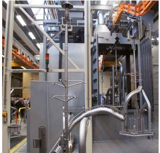
*Grenailleuse continue à charge suspendue pour constructions soudées avec des turbines disposées unilatéralement*
