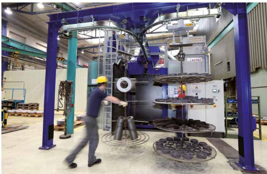
*Grenailleuse à charge suspendue pour pièces d'entraînement en solution autonome*
