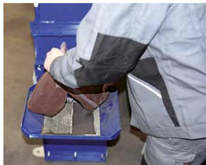
Trémie de remplissage de l'abrasif sur l'élévateur à godet (en option)
