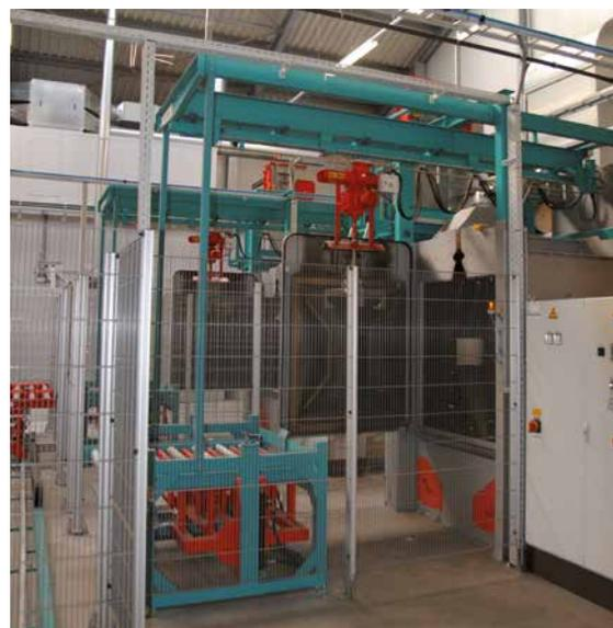
*Grenailleuse à charge suspendue pour éléments de liaison dans une ligne de traitement*
