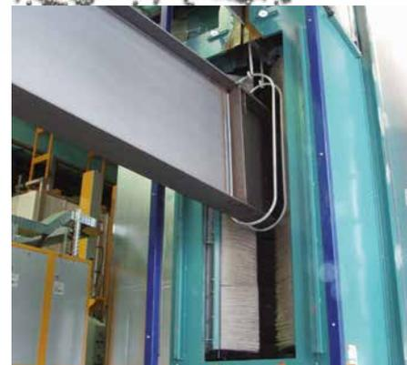
*Une poutre en acier après le grenaillage dans une grenailluse continue à charge suspendue*
