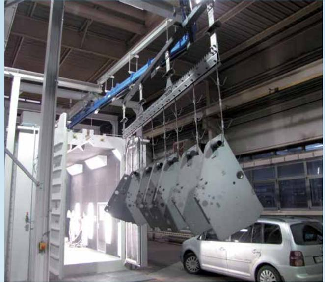
*Ligne de grenaillage à charges suspendues continues pour nettoyage de pièces de structure*
