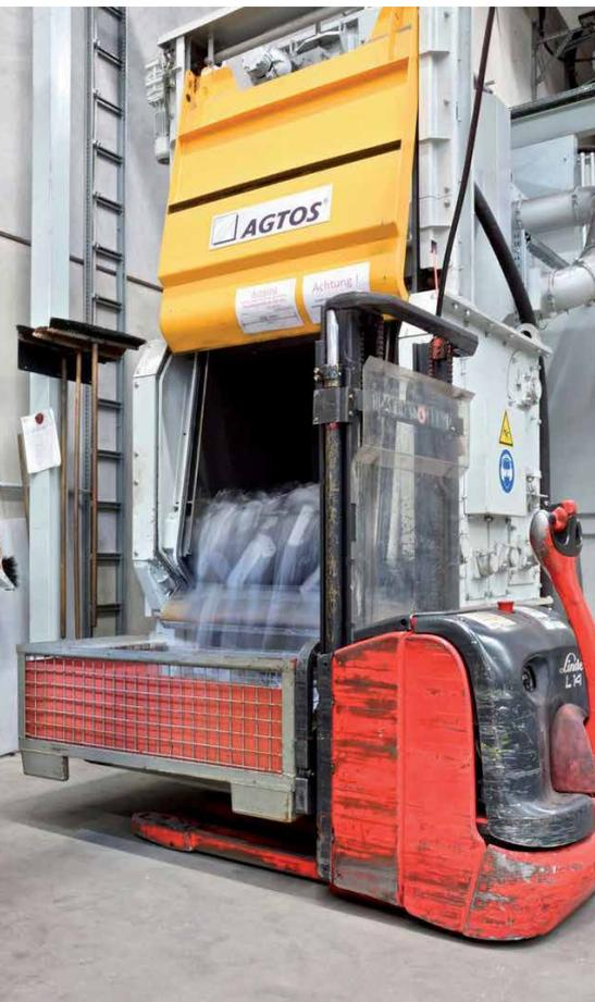
*Ligne de grenailage à convoyeur à bande en auge pour traitement de pièces de petites dimensions*
