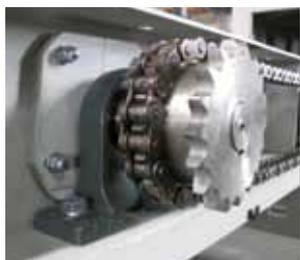
Les roulements sur palier sont installés en dehors de la machine
