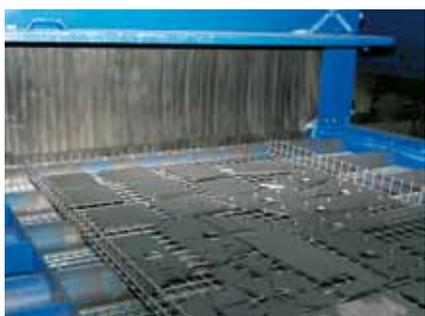
*Grenailage des pièces oxycoupées disposées dans un panier*
