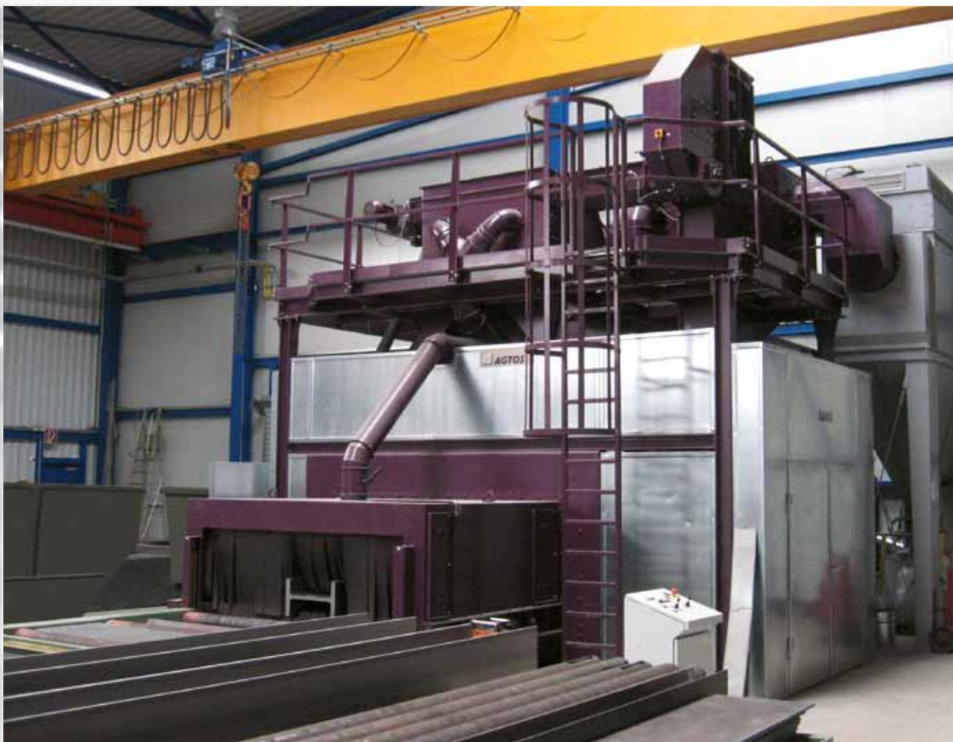
Celles-ci sont utilisées pour décalaminer et décaper les profilés, des tôles et des éléments mécano-soudés constructions. Grâce à un système de convoyeurs à rouleaux, certaines séquences de fabrication, telles que le grenailage, la préparation des surfaces, le sciage et le perçage, peuvent être reliées entre elles. Cela permet d'atteindre une souplesse dans le procès de fabrication et d'assurer ainsi un grand débit de produits en flux tendu.
