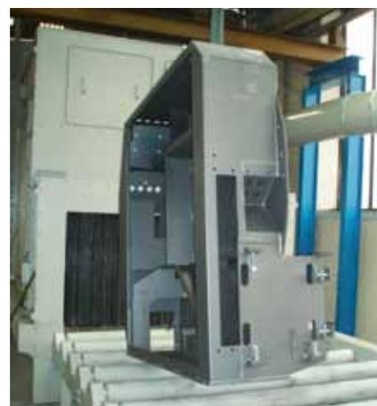
*Grenailleuse pour profilés, tôles et des éléments mécano-soudées jusqu'à une hauteur de 1000 mm*
