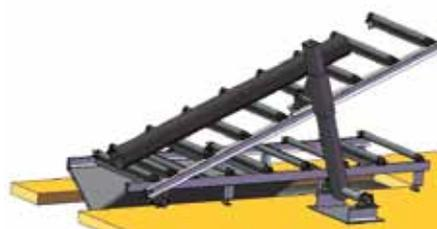
*Dispositif de renversement pour vider l'abrasif des tubes après grenailage*
