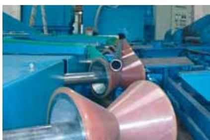
*Grenailleuse à rouleaux diabolos pour le traitement de tube anti incendie*
