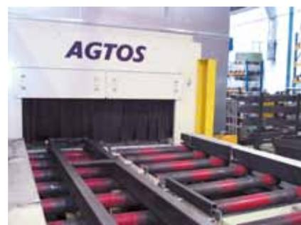
*Grenailleuse à hauteur de passage variable*
