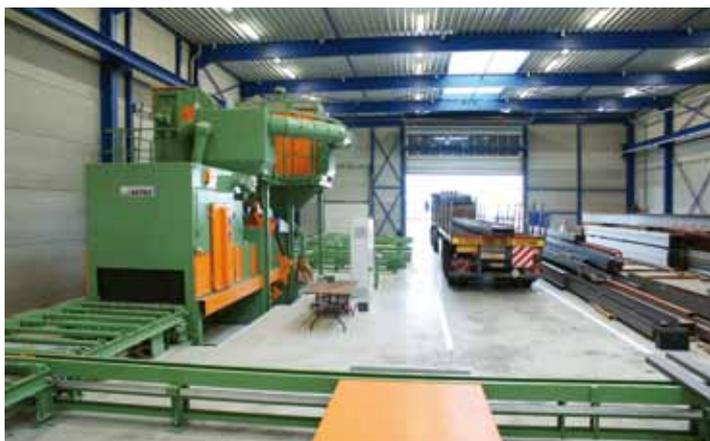
*Des transbordeurs transversaux relie la grenailleuse aux machines de sciage et perçage*
