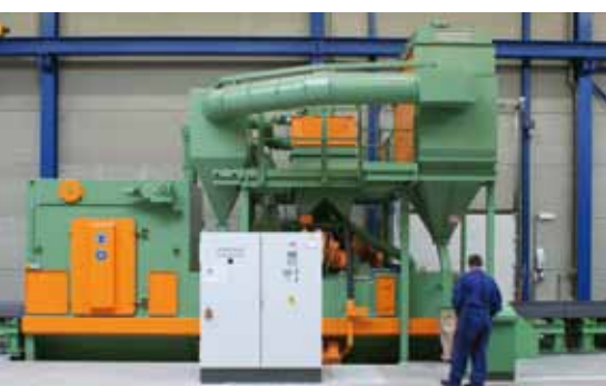
Oczyszczarka AGTOS z wyraźnie widocznymi drzwiami inspekcyjnymi
