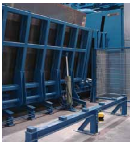
Oczyszczarka z pionowym przenośnikiem rolkowym
