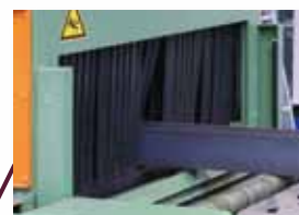
Układ automatycznego rozpoznawania kształtu obrabianego elementu przy wjeździe do oczyszczarki
