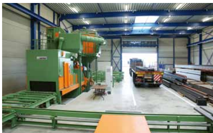
Oczyszczarka jest połączona ze stacją cięcia i wiercenia za pomocą przenośnika poprzecznego
