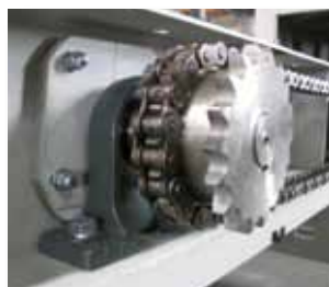
Łożyska rolek transportowych umiejscowiono na zewnątrz maszyny
