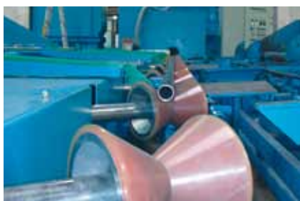
Oczyszczarka do rur z rolkami typu Diabolo
