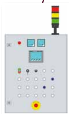
Szafa sterownicza – OP77B
