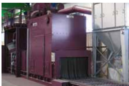
Oczyszczarka do blach, profili i konstrukcji o wysokości maksymalnej 1000 mm
