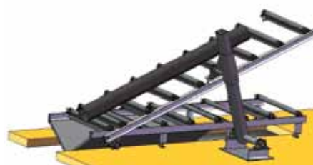
Konstrukcja pochylająca rury w celu usunięcia z ich wnętrza resztek ścierniwa
