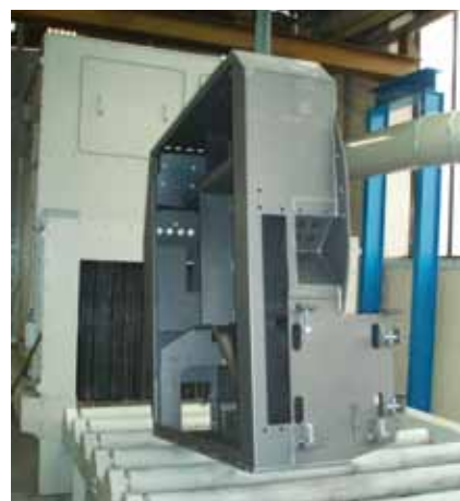
Oczyszczarka do blach, profili i konstrukcji o wysokości maksymalnej 1000 mm
