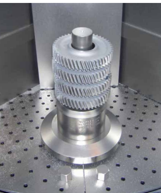
Oczyszczarka strumieniowa z taktującym stołem obrotowym do utwardzania części do przekładni
