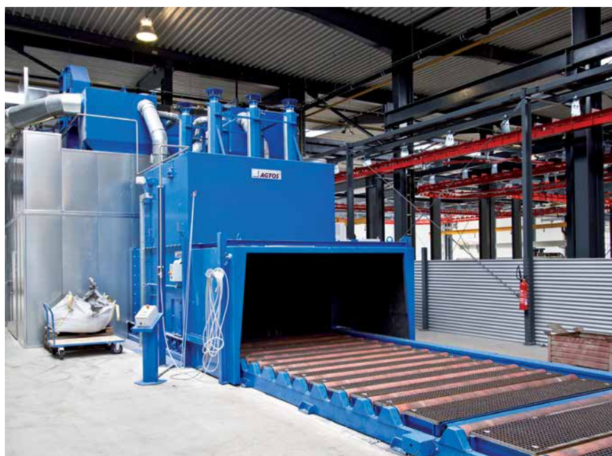
Oczyszczarka strumieniowa z przenośnikiem rolkowym do oczyszczania konstrukcji spawanych
