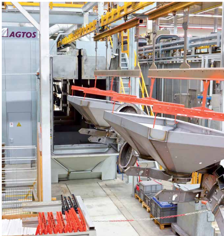
Oczyszczarka zawieszkowa przelotowa do usuwania rdzy i oczyszczania rozrzutników do nawozów i nasion
