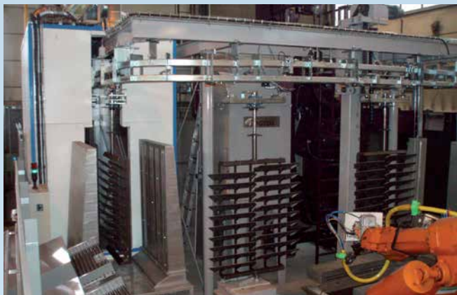
Oczyszczarka zawieszkowa przelotowa do oczyszczania elementów ciętych.
