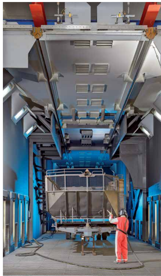
Nieoczyszczone przez turbiny powierzchnie detali można doczyszczyć w procesie ręcznej obróbki.
