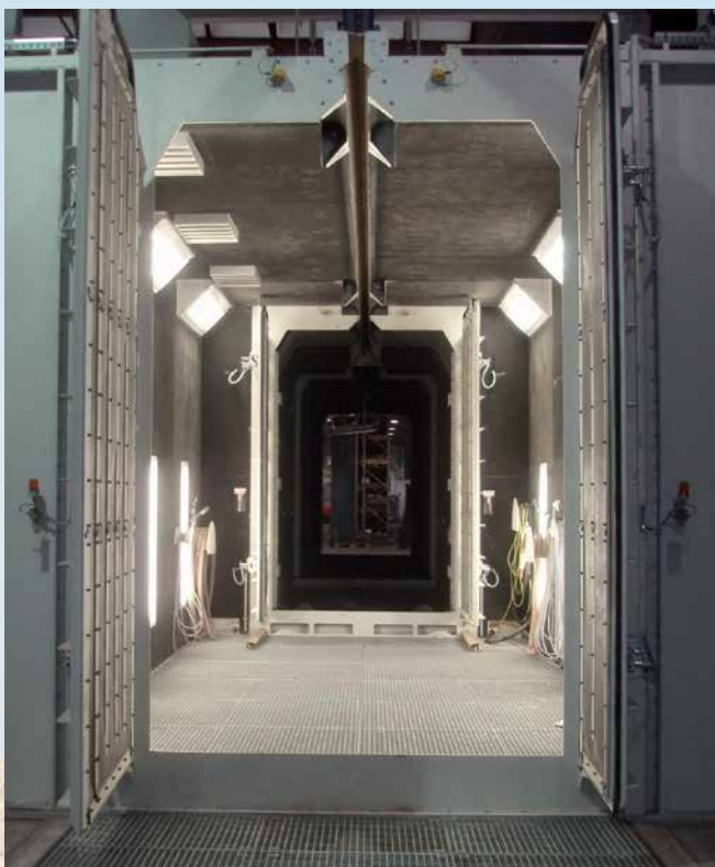
Oczyszczarka zawieszkowa przelotowa do oczyszczania konstrukcji spawanych z ręczną komorą do doczyszczania i odmuchiwania
