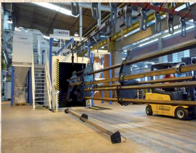
Oczyszczarka zawieszkowa przelotowa do oczyszczania konstrukcji spawanych
