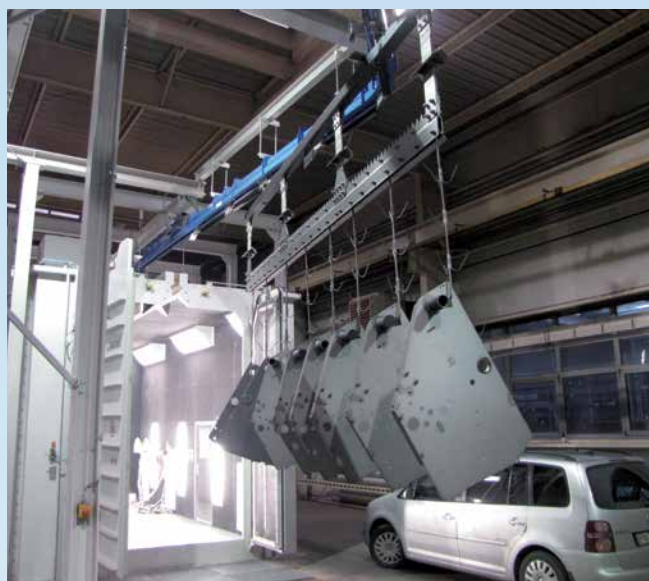
Oczyszczarka zawieszkowa przelotowa do oczyszczania elementów konstrukcji
