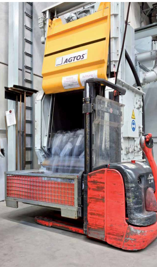
Oczyszczarka strumieniowa z taśmą nieckową do oczyszczania małych detali
